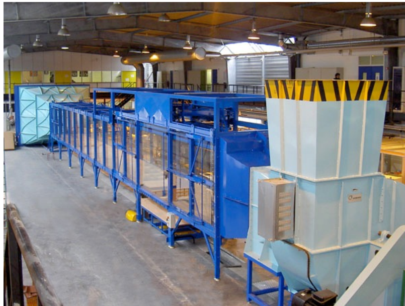
Soufflerie atmosphérique [LHEEA] (section = 2m x 2m, longueur = 20m)
